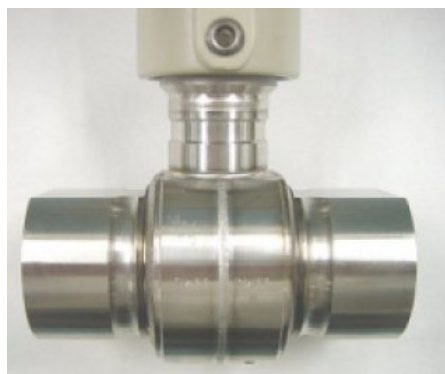
图 31 用于全焊接远传法兰的全焊接表体 全焊接的 SmartLine 变送器膜盒是全焊接远传法兰变送器的重要部分，常用于真空状态下的液位测量。
